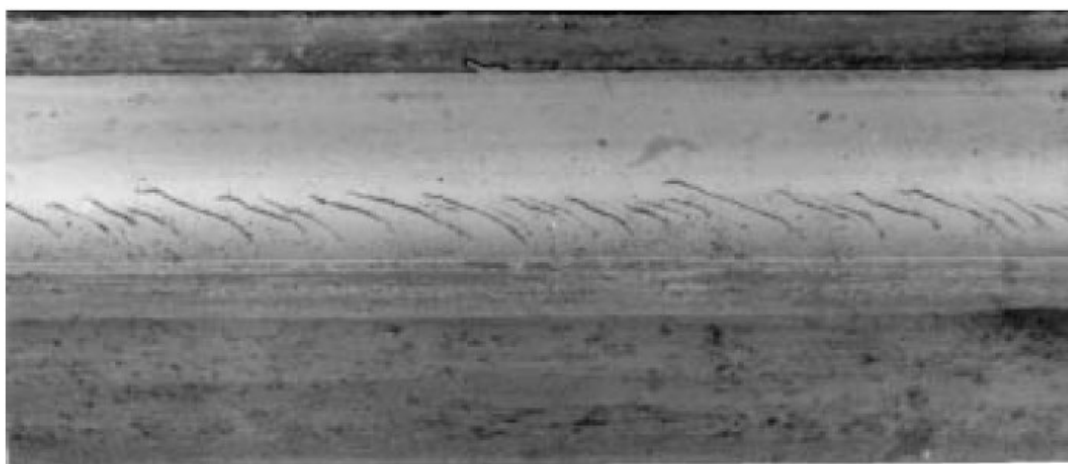
Obr. 29 Šikmé trhliny pojížděné hrany (head checking)
