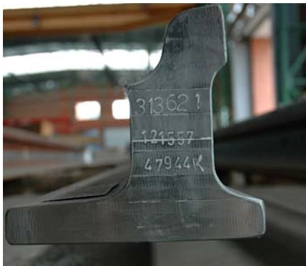
Obr. 14 Příklad identifikace jazyku-pohled z čela
