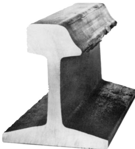
Obr. 38 Boční opotřebení hlavy kolejnice
