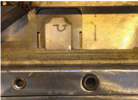
Pojistný plech se svíráním jazyka (1 půlka)
