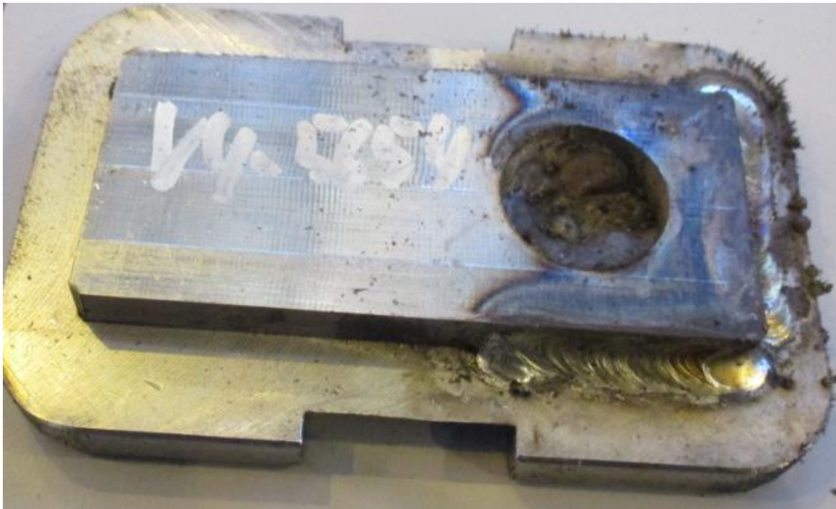
Demontovaný pojistný plech je svařencem dvou plechů
