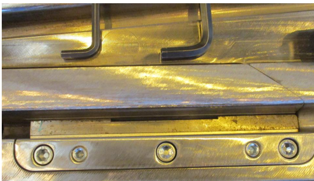
K demontáži přichytky k jazyku použít 2 imbusové klíče odpovídajících rozměrů
