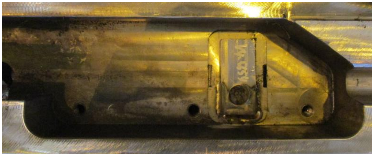
Před demontáží dvojdílného pojistného plechu zlehka poklepat
