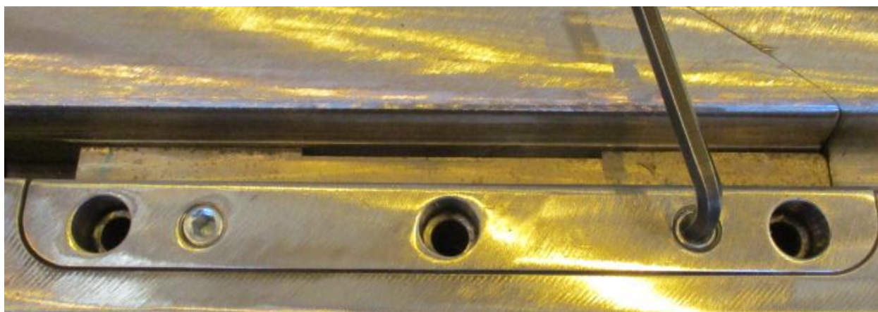
Střídavě utahovat stavěcí šrouby
